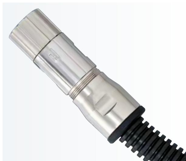
Direkter Anschluss eines Schutzschlauches am Steckverbinder über einen Adapter, der sowohl Dichtigkeit als auch Zugentlastung für Kabel und Welschlauch garantiert.
