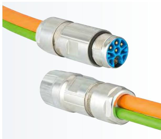
Mit Hilfe eines Multieinsatzes werden eine Cat5e-Leitung und ein Servo-Kabel in einen Stecker geführt. Der Steckverbinder mit Schnellverriegelung erzielt IP 67.
