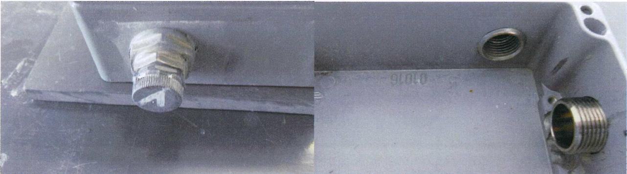
Bild 1+2: PM EXel 191/12 nach Prüfung auf Staubdichtheit
